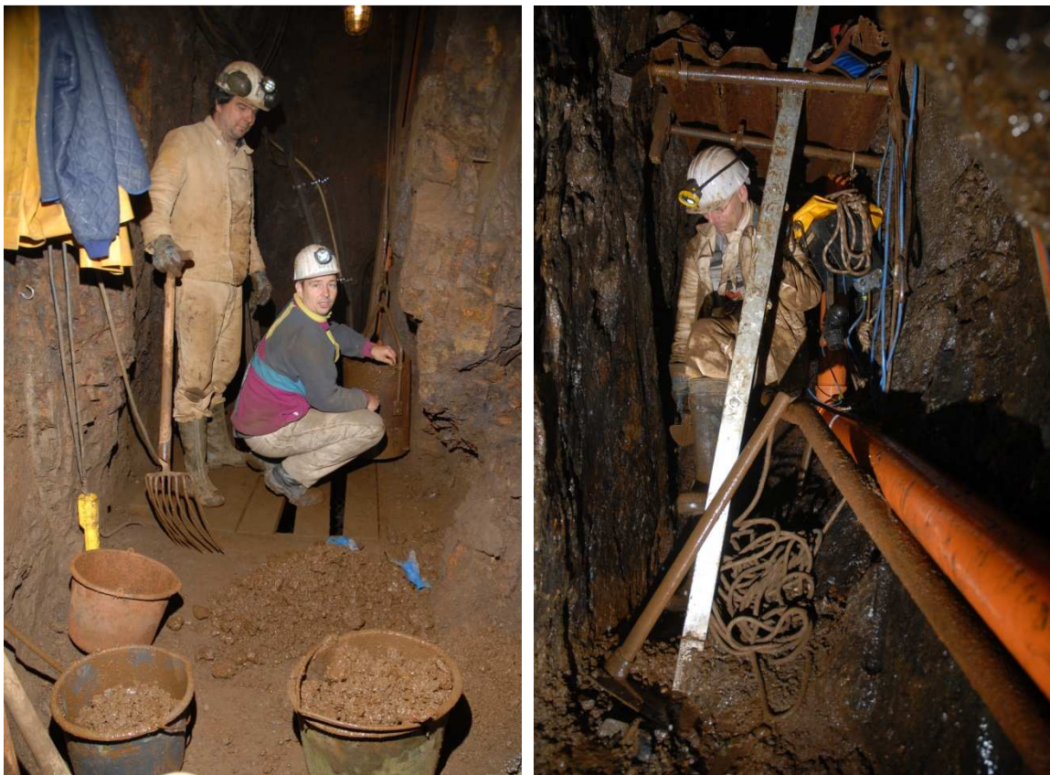
Abb. 2 (links): Zwischenförderung der Berge auf der 13-m-Sohle Abb. 3 (rechts): Schachtfuß Absinken 3. Schutz vor Steinfall bot während der Bergförderung eine behelfsmäßige Kopfschutzbühne
