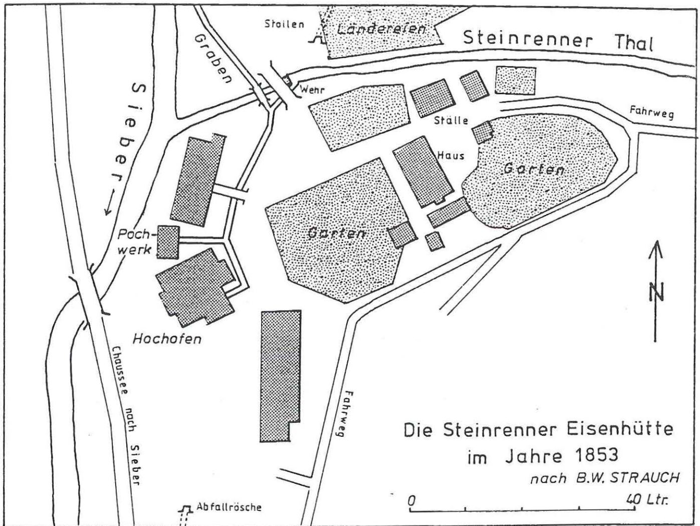
Abb.5 Bauliche Situation der Steinrenner Hütte um 1850. Eingezeichnet ist das heute noch vorhandene Mundloch der Abfallrösche.
